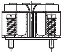
安装了变送器的接线端子板
